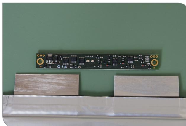
Prototyp einer Zellbaugruppe mit einer 40Ah-LiPo-Pouchzelle
