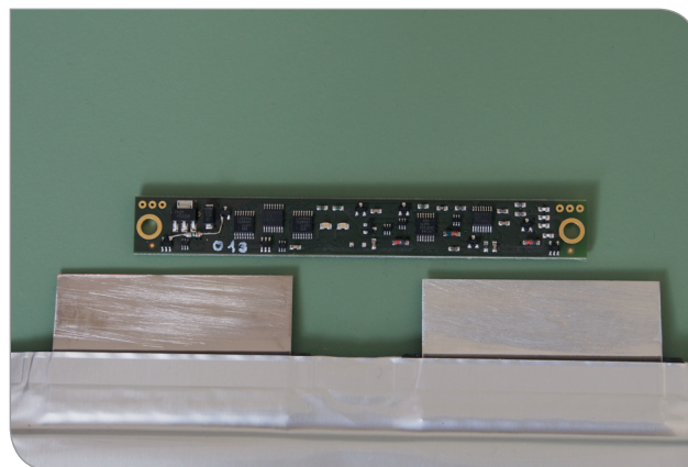
Prototyp einer Zellbaugruppe mit einer 40Ah-LiPo-Pouchzelle
