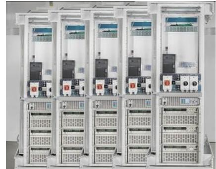
*An über 20 Testständen untersucht das Projekt „SafetyFirst“ Sicherheit, Qualität und Netzdienlichkeit von Heimspeichern für Strom aus Photovoltaikanlagen.
